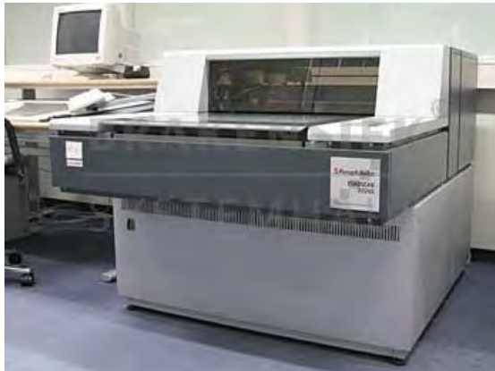
Gambar 4.10 Copydot scanner banyak dimiliki perusahaan percetakan/penerbitan
