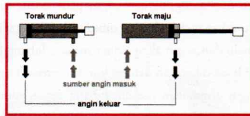
Gambar 9.6. Ilustrasi cara kerja silinder kerja ganda
