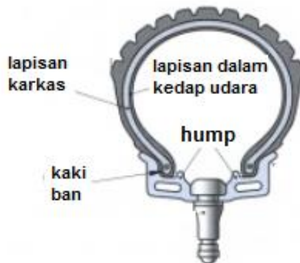
Gambar 34. Ban tanpa ban dalam (tubeless)
